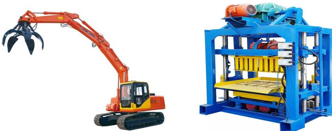
Зураг 16. Хаягдал төмрийг ачих тусгай зориулалтын механик базагч
